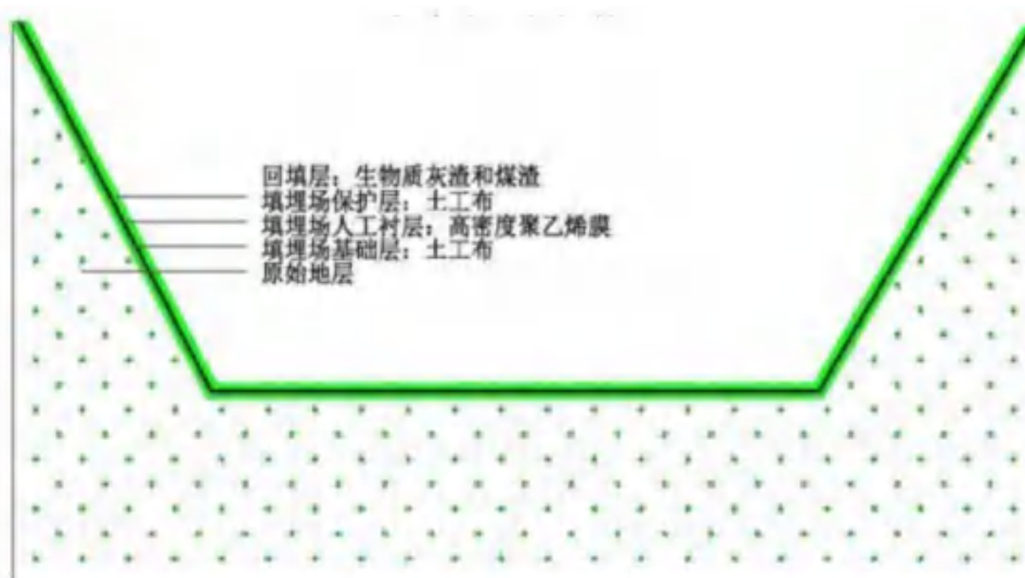
图 2-1 防渗漏工程大样图
