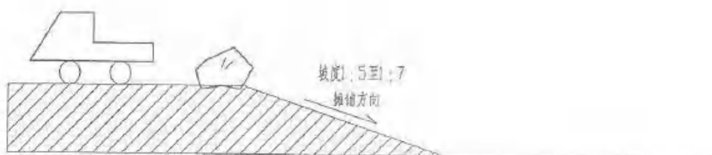
图 2-3 灰渣摊铺作业方法示意图
